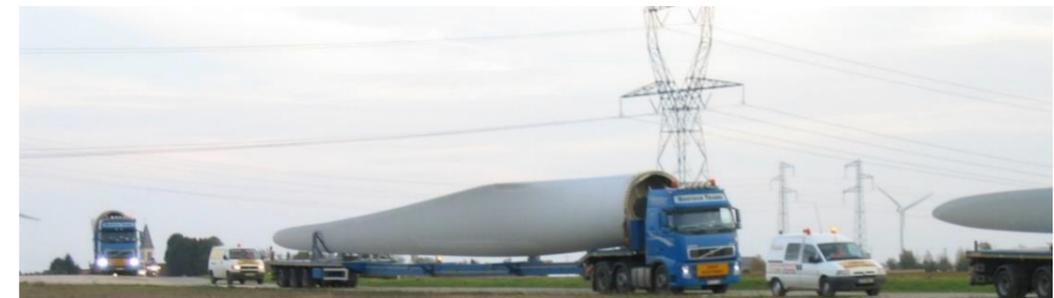
Figure 124 : Illustration du transport des pales (©ATER Environnement)
